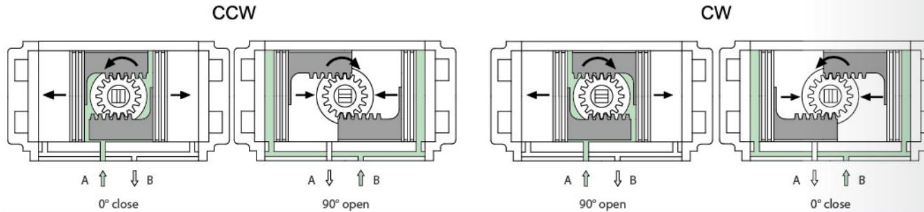
A口进气,压缩空气推动活塞向外运动,使执行器输出轴逆时针旋转( $0^\circ \rightarrow 90^\circ$ ),B口排气。
