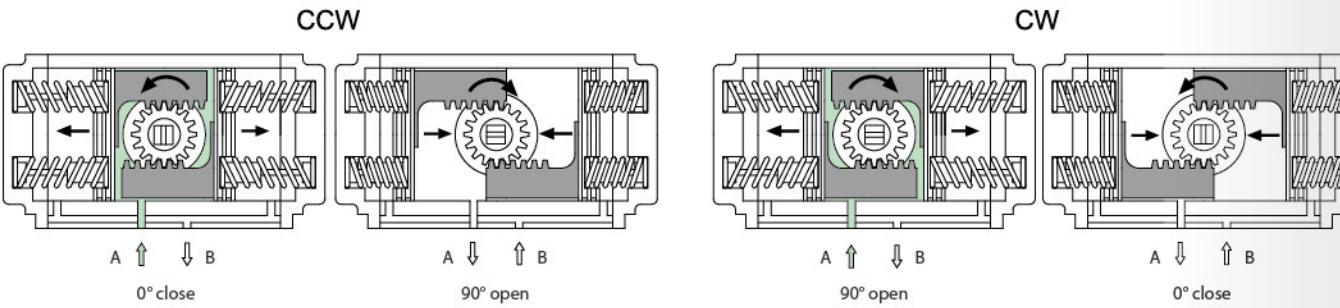
A口进气,压缩空气克服弹簧力,推动活塞向外运动,执行器输出轴逆时针转动( $0^\circ \rightarrow 90^\circ$ ),B口排气;
